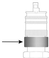
Zur Erinnerung: Beim Trennen der Mutter Kupplung vom Typ „Interspiro“ muss der Schließring vollständig herausgeschraubt werden, bevor die Kupplung gelöst wird, um ein Ausströmen zu verhindern zu vermeiden.
